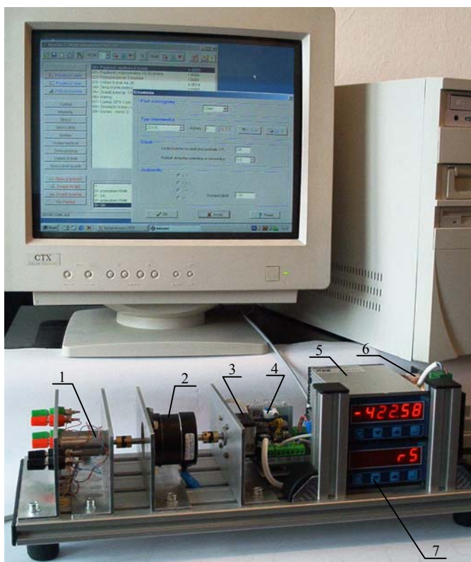
Rys. 2. Widok stanowiska laboratoryjnego do badania transformatora położenia kąowego sterowanego za pomocą komputera
